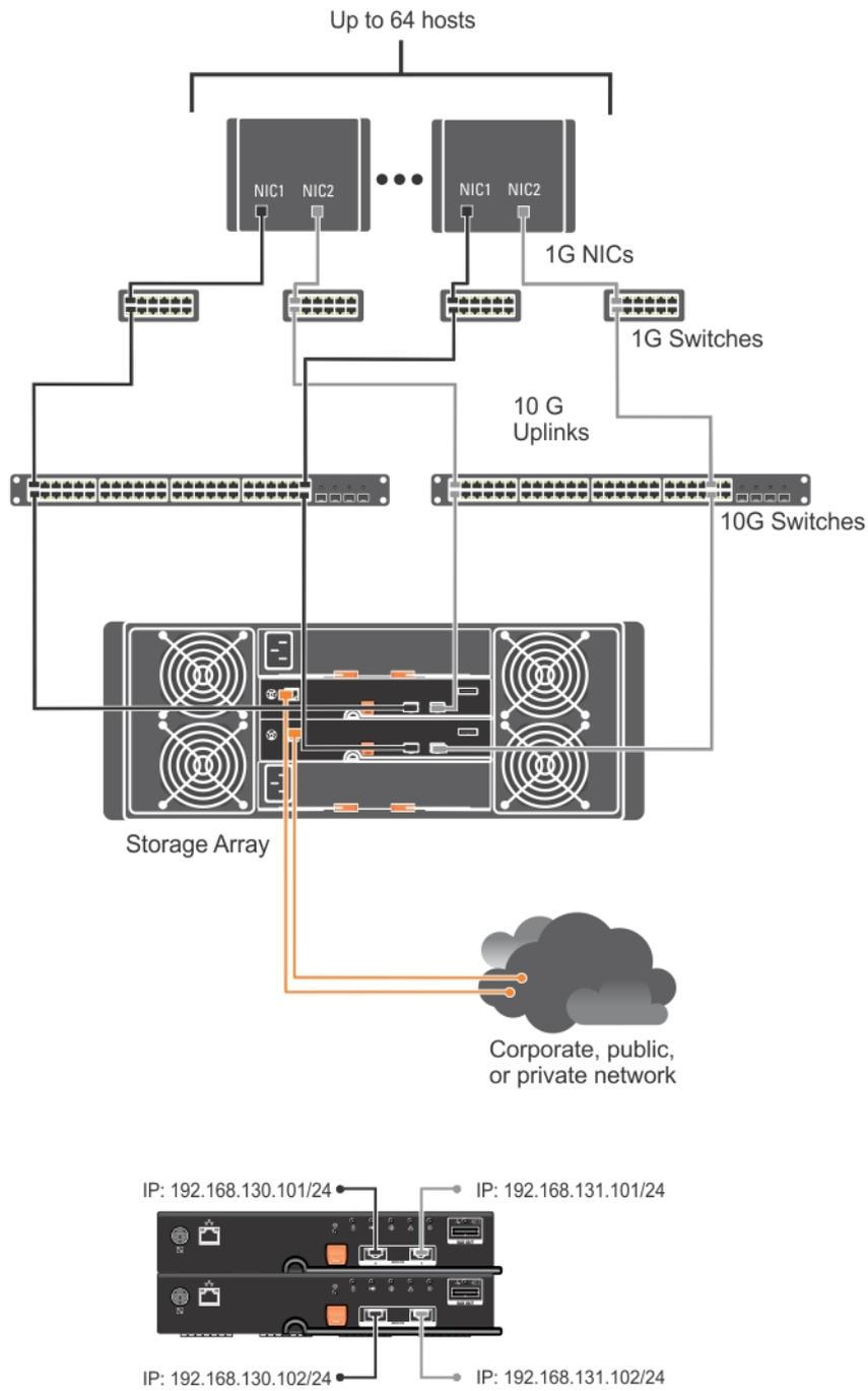
图 5: 64 台服务器连接到两个 RAID 控制器
