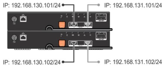
图 3: 两个群集节点连接至两台控制器
