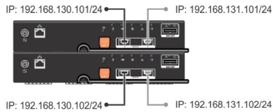
**图 2: 两台主机连接到两个控制器**
